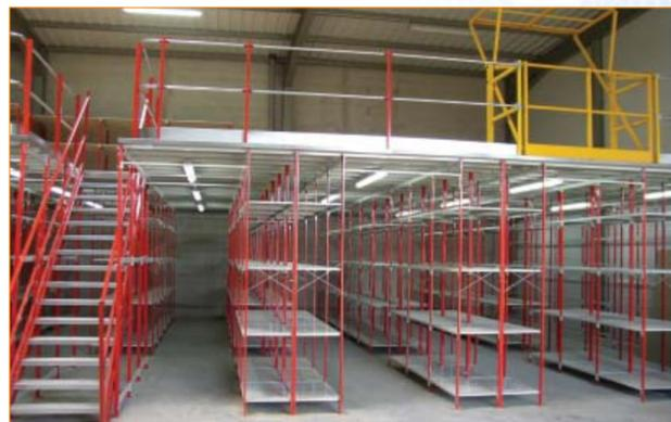
Plate-forme sur rayonnage avec tablettes tôleées.
